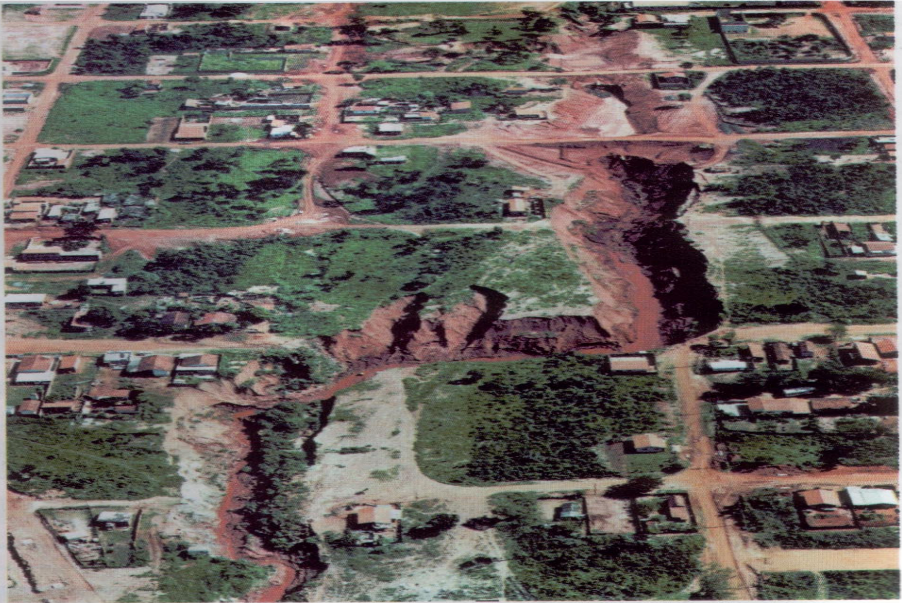
Boçoroca na região urbana do município de Bauru (SP), desenvolvida sobre o manto intempérico em arenitos da bacia do Paraná. Foto de 1993, arquivo IPT-SP.
